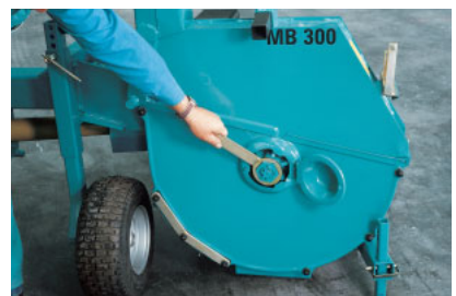
Einfaches Nachstellen des Messers zur Gegenschneide Simple knife resetting to adjust gap to cutter frame
