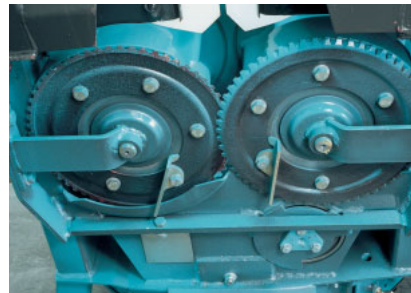
2 selbstschärfende, gezahnte Messerscheiben 2 self-sharpening, toothed knife rotors
