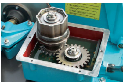
Ölbath-Schaltgetriebe für Schnittlängenverstellung Oilbath switch gear for cutting length adjustment
