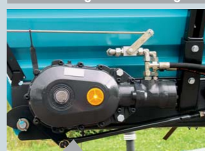
Hydr. Kratzbodenvorschub für stufenlose Geschwindigkeitsregelung
