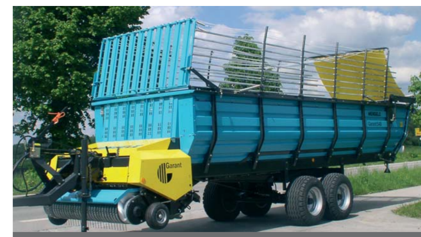
LW 548 GARANT: Der größte der GARANT-Klasse mit 29 DIN m 3 . Sein Ladevolumen und seine robuste Technik machen ihn zu einem besonders leistungsstarken Erntefahrzeug. Er ist wahlweise mit Dürrfutteraufbau oder mit Ganzstahlaufbau lieferbar.
