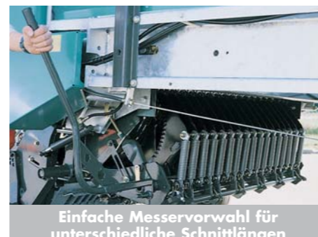
Werkzeugloser Messerausbau durch Lösen der Sicherungsfeder
