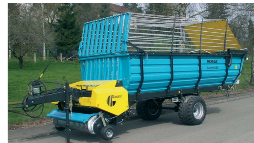
LW 334 GARANT: Der Einachsler mit 3-Schwingen-Förderaggregat. Die wirtschaftliche Variante für Klein- oder Mittelbetriebe - insbesondere für Grünfutter. LW 534 GARANT: Mit leistungsstarkem 5-Schwingen-Förderaggregat und abklappbarem Dürrfutteraufbau. Optional auch mit Tandemachse lieferbar.
