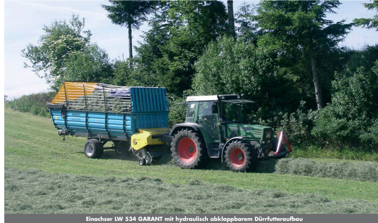
Einachser LW 534 GARANT mit hydraulisch abklappbarem Dürrfutteraufbau
